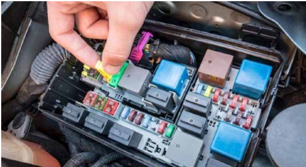
Figura 2.7. Caja porta fusibles
