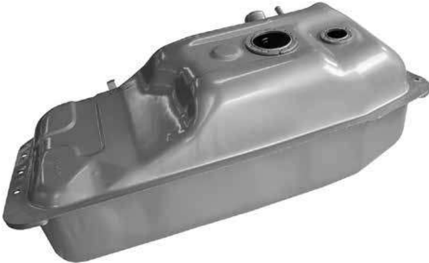
Figura 2.79. Depósito de combustible
